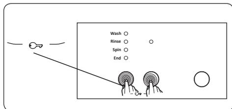
La funzione Blocco bambini impedisce il funzionamento involontario della macchina o da parte di bambini non sorvegliati.
