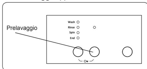
Questa funzione consente di effettuare un prelavaggio per il bucato molto sporco prima che venga eseguito il programma di lavaggio principale. Quando si utilizza questa funzione, è necessario mettere il detersivo nello scomparto di lavaggio anteriore del cassetto del detersivo.
