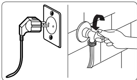
Prima di eseguire la manutenzione e la pulizia dell'apparecchio disattivare l'alimentazione elettrica e rimuovere la spina dalla presa.
